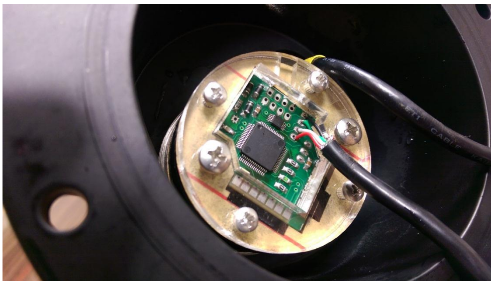
شکل ۳-۱: تصاویری از سنسور باز شده بعد از قرار گرفتن به مدت ۳۰ دقیقه در زیر آب به عمق ۱/۰ متر
