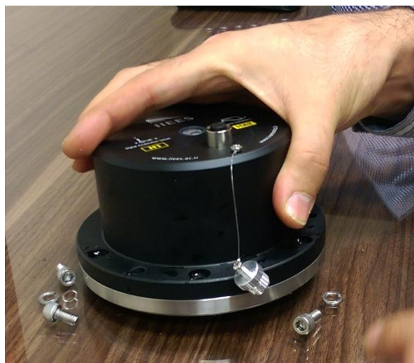
شکل ۳-۱: تصاویری از سنسور باز شده بعد از قرار گرفتن به مدت ۳۰ دقیقه در زیر آب به عمق ۱/۰ متر
