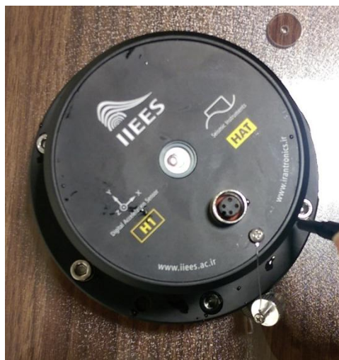
شکل ۳-۱: تصاویری از سنسور باز شده بعد از قرار گرفتن به مدت ۳۰ دقیقه در زیر آب به عمق ۱/۰ متر
