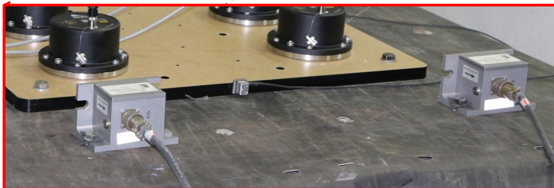
شکل ۶-۰: نحوه‌ی قرارگیری سنسورهای شتابنگاری CMG-5U
