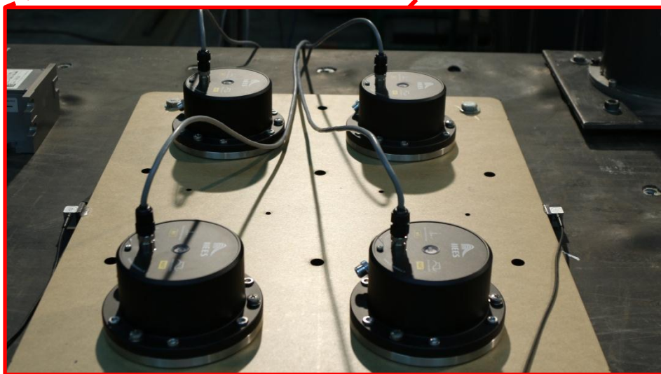
شکل ۵-۰: نحوه‌ی قرارگیری سنسورهای HAT بر روی میز لرزه
